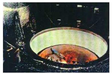
エンジンブロックのシリンダーライナーの密閉面の漏れている部分から冷却水が流出していました。
