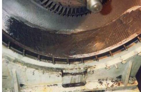
航海中に故障が発生し、船上でターボ・チャージャーの補修しました。タービン入口のケースをはずし、きれいになるとケーシングの底部分の破損箇所(約600×130mm)が明らかになりました。船上という技術的制約上、MM-メタルSS-スチールセラミックと補強としての鋼板を使用して補修しています。修復した部分の排気温度は約400℃でしたので、マルチメタル製品の「VP10-500」を選択した方が、有効で有ったかもしれません。
