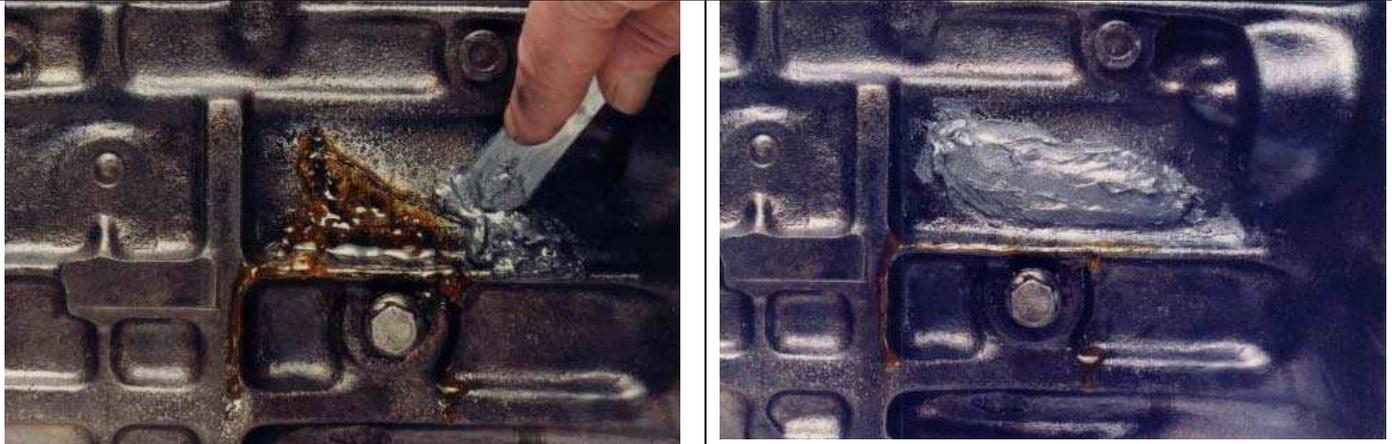
MM-メタル oL-スチールセラミックと硬化剤(赤)を用いてマンケースの補修をしました。この作業は「直接MM接着法」と呼ばれています。
