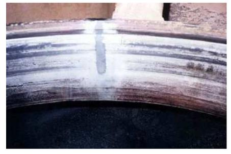
MM-メタルSS-スチールセラミックと硬化剤(黄)を用いた船舶用エンジンの補修です。
