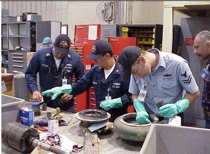
使い込んだポンプ・ケーシングをデモンストレーションの目的でセラミウムで補修しています。
