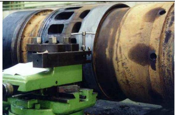
サルサー社の定期船RND76Nのディーゼルエンジンの2ストロークシリンダーライナーをMM-メタル SS-スチールと硬化剤(黄)で修理しました。(外径900mm, 内径760mm)
