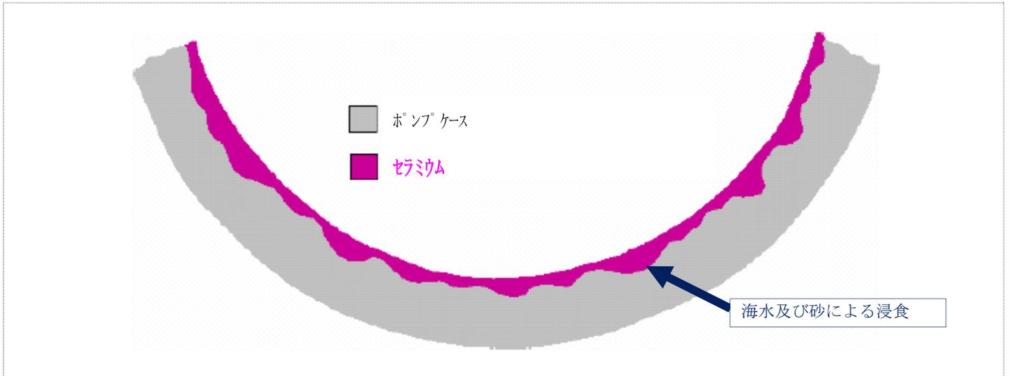
“セラミウム”は、酸化・腐食・浸食・作巢・磨耗等の非常に厳しい破壊圧力を受ける金属部品表面の耐食性コーティングとして使用する事により、非常に高い耐摩耗・耐薬品性を備えます。
