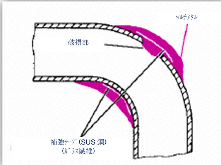
マルチメタル SS が大きな割れ穴に沈み込んでいくのを防ぐ為、「補強テープ」を使用すると良いと思われます。補強テープは自在性に富み、補修部の複雑な輪郭に合わせられます。
