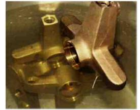
\* “セリウム”は、毛管作用で微細な穴、クラックに入りシールします。
