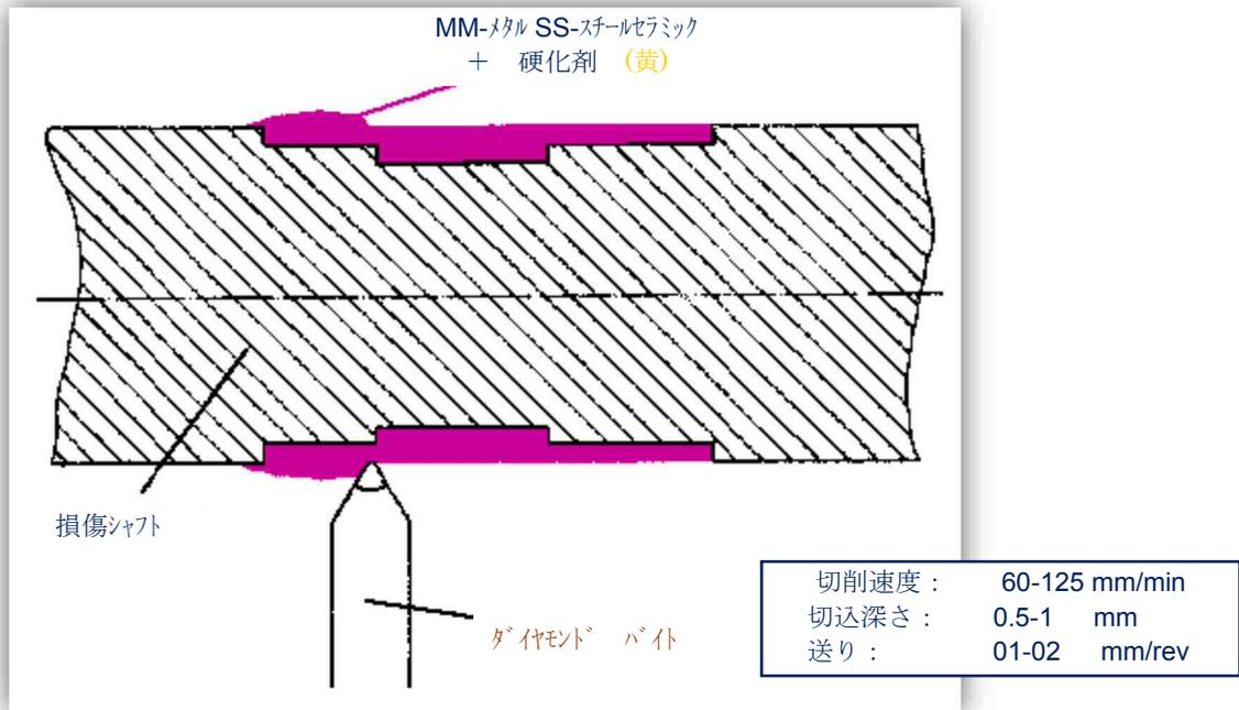
スチールセラミックベースのMM-メタルの機械加工には、ダイヤモンドバイトが表面精度も良く、また長持ちします。
