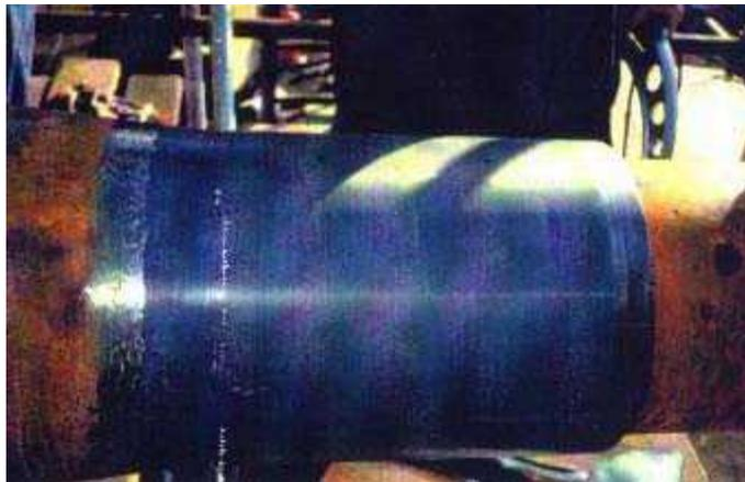
露天掘り用バケットホイールエキスカベーターをセラウム(液状タイプ)で補修しています。磨耗のダメージを受けたバケットホイールの主駆動軸(全長400mm, 直径360mm)が修復されました。修復により直径は350mmになっています。
