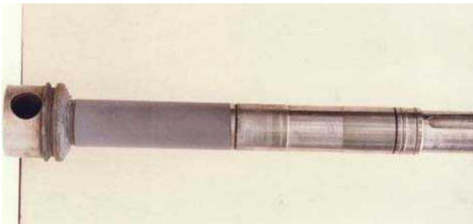
セラミウムと硬化剤CEを使用して、塗装機のシャフトのパッキンボックス内部にあたる部分を修復しています。以前からの一般的金属溶射による補修方法は、機械停止時間が長すぎる為、熟考の上選択されませんでした。
