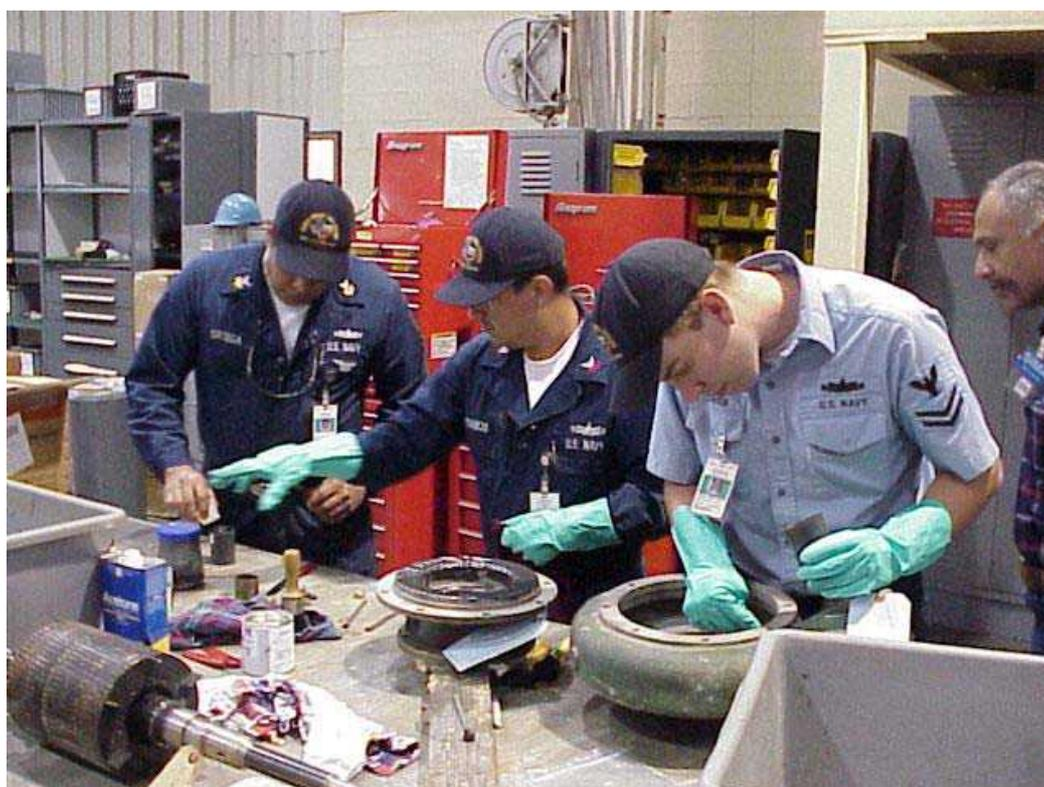
経年劣化したポンプ・ケーシングをデモンストレーションの意味でセラミウムを使用して補修しています。セラミウムの適用は刷毛、ヘラ、その他妥当な道具を使用して、流し込む、注入する、等で適用する事が出来ます。塗布する前に表面を粗くして、例えばサンドブラスト等で、そしてMM-ディグリーザーかアセトン等で洗浄しておきます。
