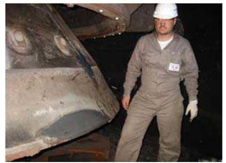
製鉄所において、溶鉱炉に生じたひどい侵食です。コンベアコンの数箇所はコークによって断続的に起きる激しいダメージの為 コーンに溶接された数枚の鉄板にセラミウムを塗布し、加えて他の数箇所と機器について再び作業がしやすい様にしています。
