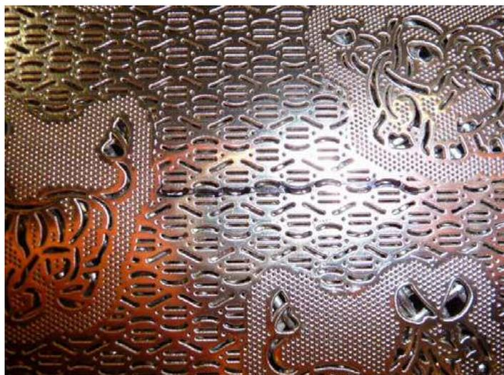
フリスなどの素材に通貨の様に模様を入れるニッケルドラムにクラックと割れ目が見つかりました。割れが発見された場所は厚み2mmと非常に薄く安定させなければなりません。修理しなければ素材がドラムに巻き込まれてしまう危険があります。アセトンで脱脂洗浄された後、セラミウム BDは適用され亀裂と割れ目は埋められました。これらの部分は再び磨かれ、妥当な輪郭に削られました。その後表面はセリウムでコーティングされ、網状スクリーンの補修作業終了の後、通常の作業状態に戻されました(作動圧170バール)
