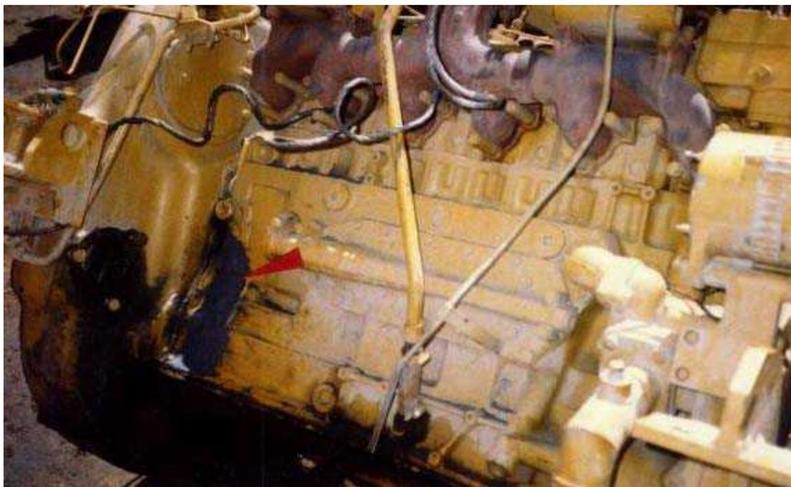
ブルドーザー(小松製)のエンジンブロックに生じた長さ約20インチの毛割れの修復をしています。最初に試みた電気溶接はうまくいきませんでした。しかし、「直接MM接着法」でMMメタルoL-スチールセラミックを塗布する事で修復に成功しました。
