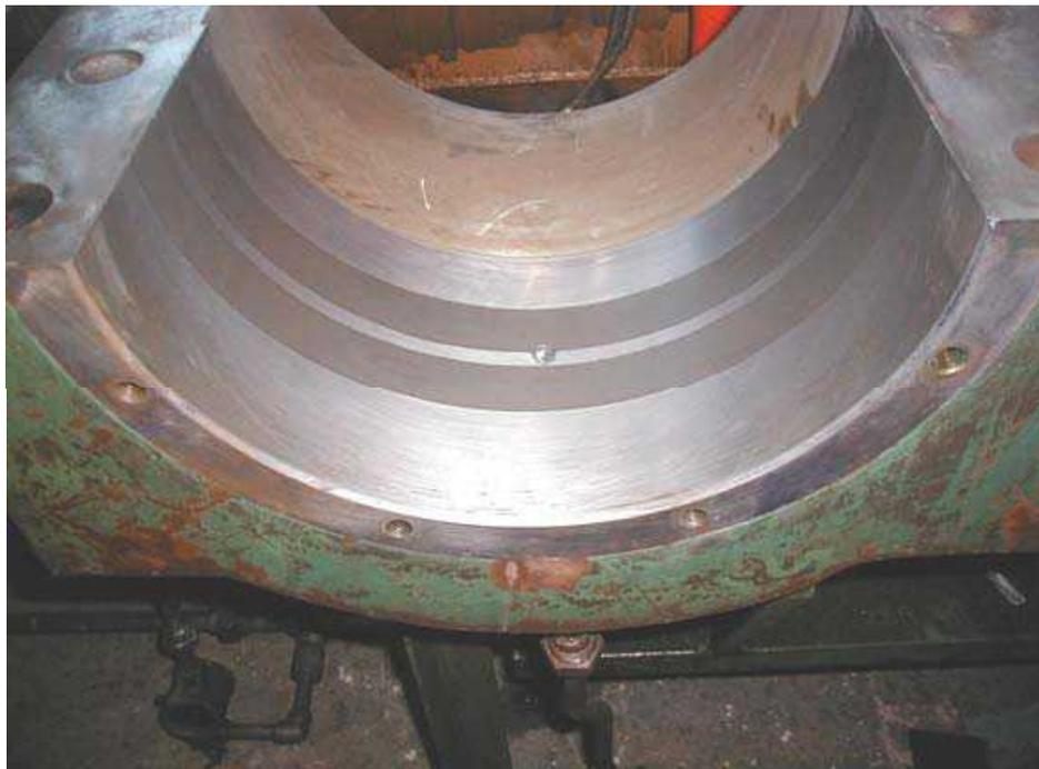
鉄鋼工場の破損した重量40トンのスプールのユーザーの修復です。従来の溶接による方法なら10日はかかっていたでしょう。ポリマーメタルよりMMメタルSS-スチールとMMリリエージェントを合わせたマルチメタルの補修技術を使う事によって、修復時間は27時間必要でした。スプールのユーザーには120Mpaの負荷がかかります。
