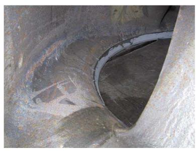
摩擦によって磨り減った浚渫用ポンプの金属製のリングは当然交換しなければならなかった。MM-メタルSS-スチールが新 しい金属リングの代わりになりました。MM-メタルSS-スチールにおいて30Mpaに及ぶ高い破断強度をポリマーメタルは提供 しています。
