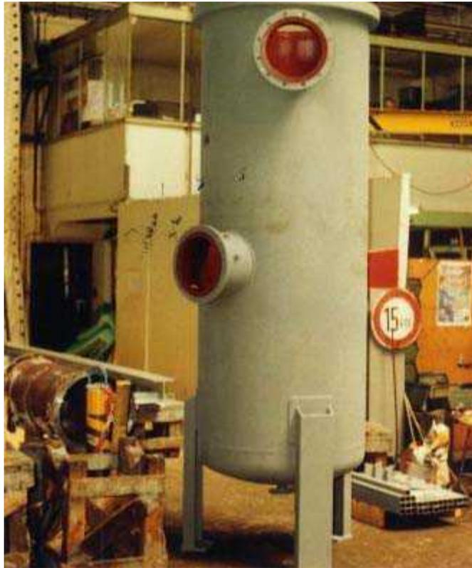
空気冷却機のタンクと他の大きな表面をVP10-017でコーティングしています。VP10-017の非常に滑らかな表面は表面保護と耐腐食性に富み、弾力性と耐磨耗性の表面を作ります。VP10-017は、100 までの耐熱性と非常に高い薬品対抗性を備えています。
