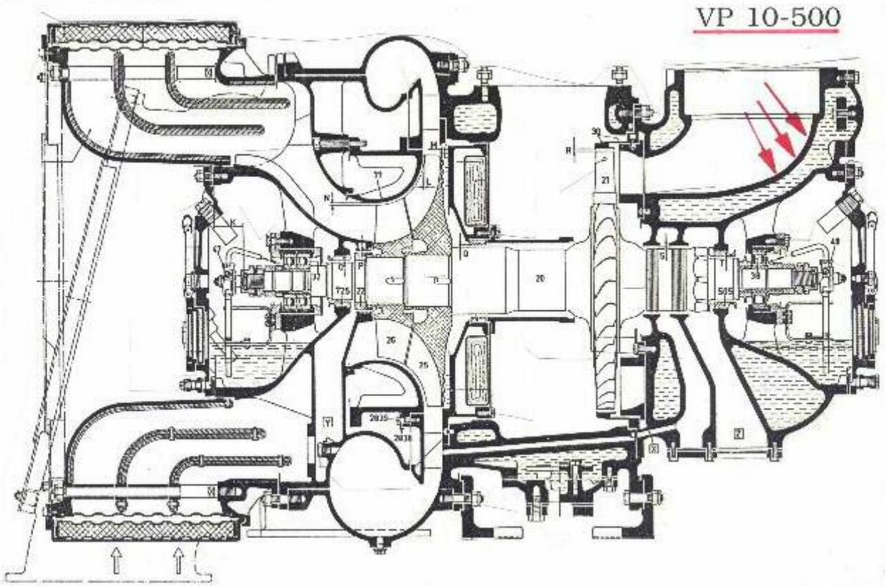
VP10-500を使用して船舶のターボチャージャーを補修しています。ガス入口から冷却水側にいたる傷んだ部分、亀裂、隙間にVP10-500を塗布しました。MM-ファブリックテープ(グラスファイバー)を使用して二層目を塗り、補強しています
