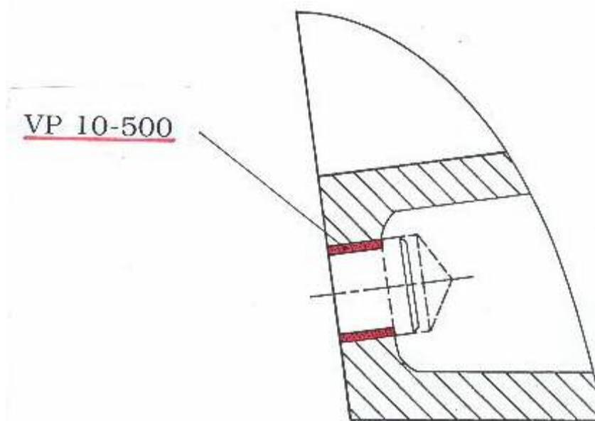
VP10-500を使用して排気ポートのシリンダーヘッドに付いている排気プラグを補修しました。
